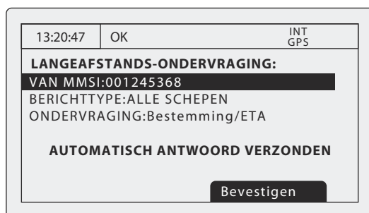
Afbeelding 18 Melding langeafstands-ondervraging; automatische antwoordmodus ingeschakeld
