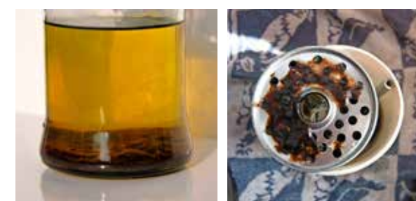
Links: met bacteriën verontreinigde gewone diesel. Rechts: de gevreesde bacterietroep in het filter.
